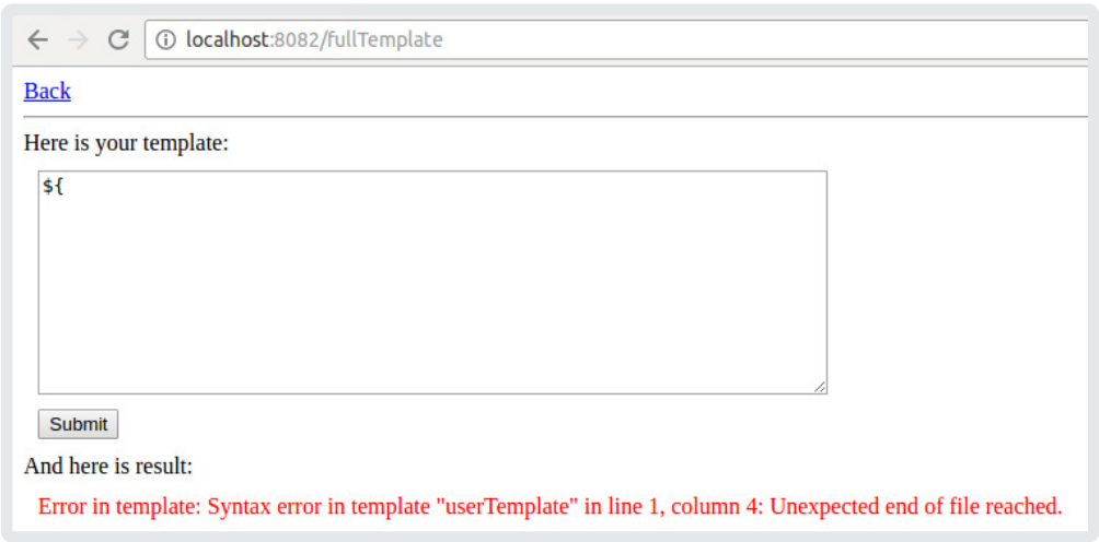
Rysunek 12. Kolejny sposób na identyfikację podatności – wymuszenie parsowania
